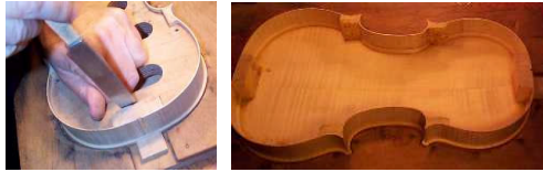
Resim 2.12: Kalıbın çıkarılması
