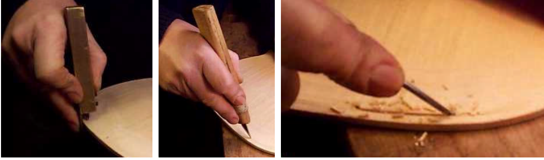
Resim 2.4: Filato kanallarının açılması
