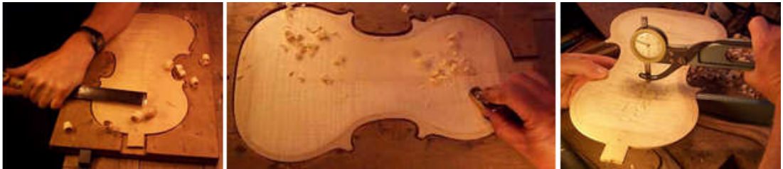
Resim 2.10: Alt tablonun iç bombesinin verilmesi ve saatli kalibre aleti ile ölçülmesi
