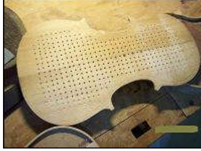
Resim 2.11: Tablonun delikler açılarak kalınlığının belirlenmesi
