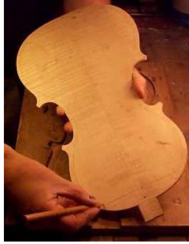
Resim 2.9: Alt tabloda yanlık ve blok yerlerinin tespit edilmesi
