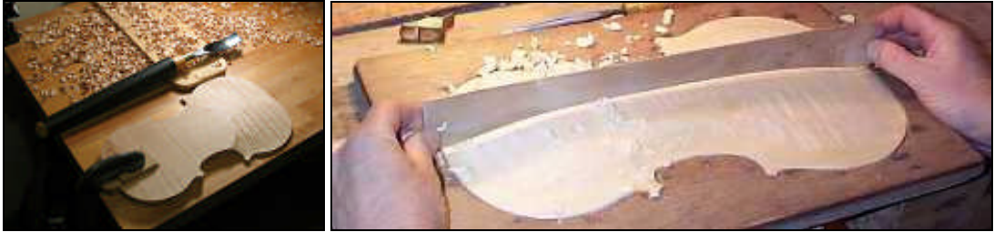
Resim 2.3: Tablolara dış bombenin verilmesi ve bombe kontrolü
