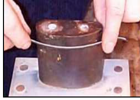
Resim 2.5: Filatoların alıştırılması
